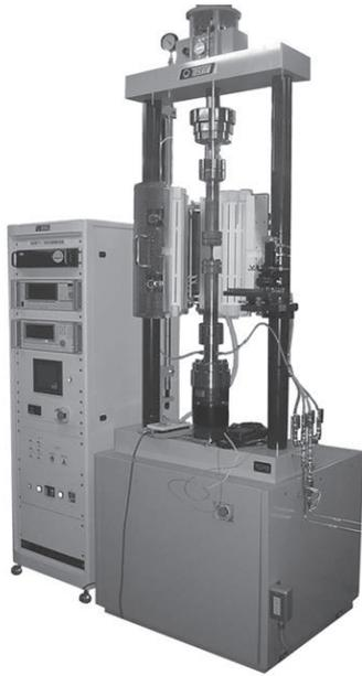
火力、原子力発電プラントの熱交換器、圧力容器などの高温機器の構造部材には、起動・停止や出力変動時の過渡的温度変化に伴い、熱応力が発生し、この熱応力の変化により疲労とクリープを生じます。これらのクリープ疲れ特性を得るための試験装置で、高温機器構造材の寿命を予測することができます。
