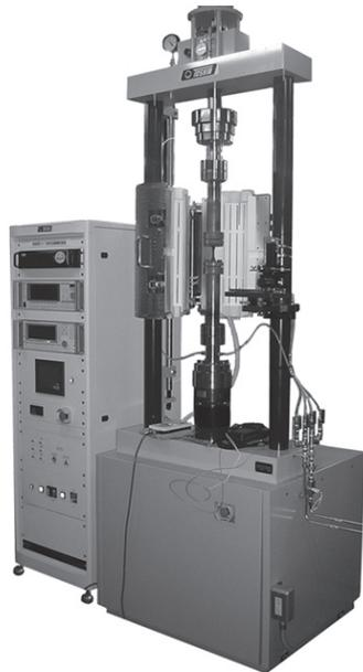
火力、原子力発電プラントの熱交換器、圧力容器などの高温機器の構造部材には、起動・停止や出力変動時の過渡的温度変化に伴い、熱応力が発生し、この熱応力の変化により疲労とクリープを生じます。これらのクリープ疲れ特性を得るための試験装置で、高温機器構造材の寿命を予測することができます。
